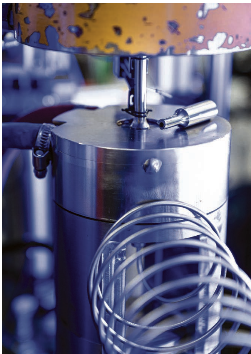
Mittels Hohlprobentechnik werden Schwingfestigkeitswerte unter Wasserstoffeinfluss ermittelt.
