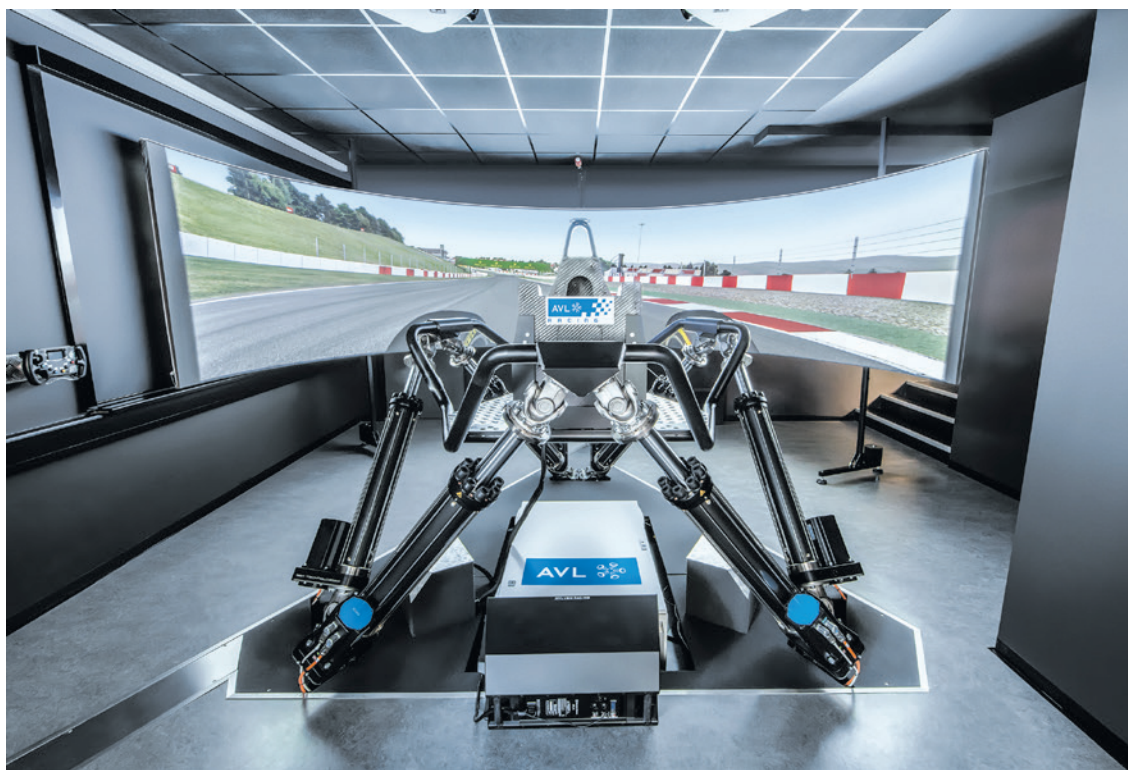
DER AVL-RACING- Fahrsimulator verbindet Simulation mit realen Fahrzeugtests, indem am Simulator beliebige virtuelle Strecken gefahren werden und gleichzeitig das reale Fahrzeug am Prüfstand nebenan betrieben wird.
