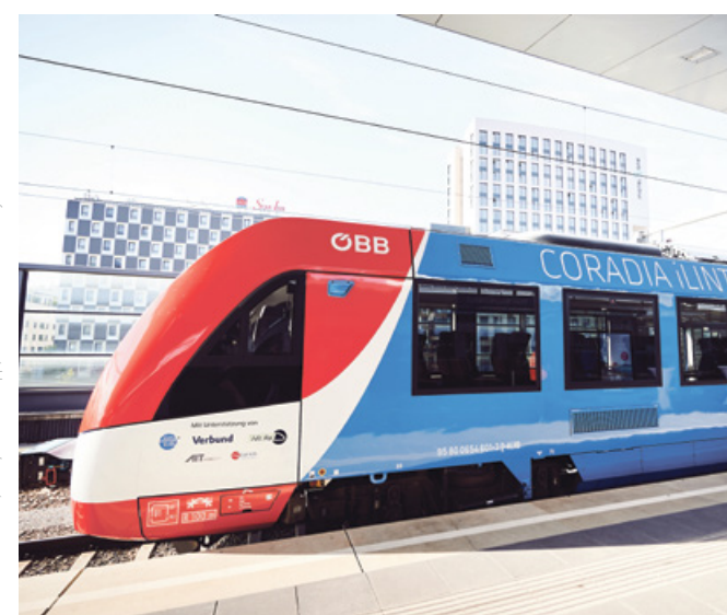
EIN MIT WASSERSTOFF betriebener Zug von Alstom war bereits bei den ÖBB im Testeinsatz.
