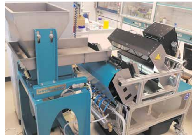
Sensorgestützter Sortierstand der Montanuniversität.
